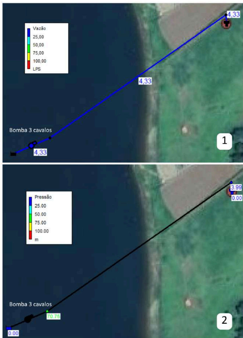
Figura 8: Simulação de valores de pressão e vazão para a Estação Elevatória de Água Bruta
