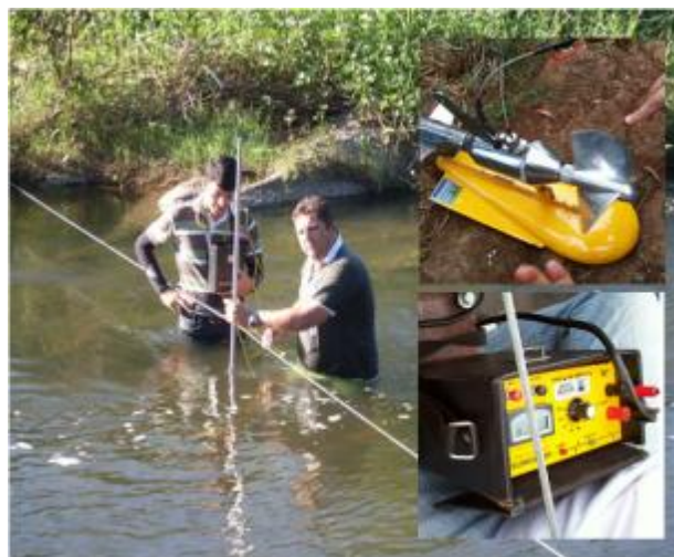
Figura 3 - Medição de vazão com o molinete fluviométrico e contador de pulsos na seção transversal do Rio Piancó. Arquivo pessoal (2011)
