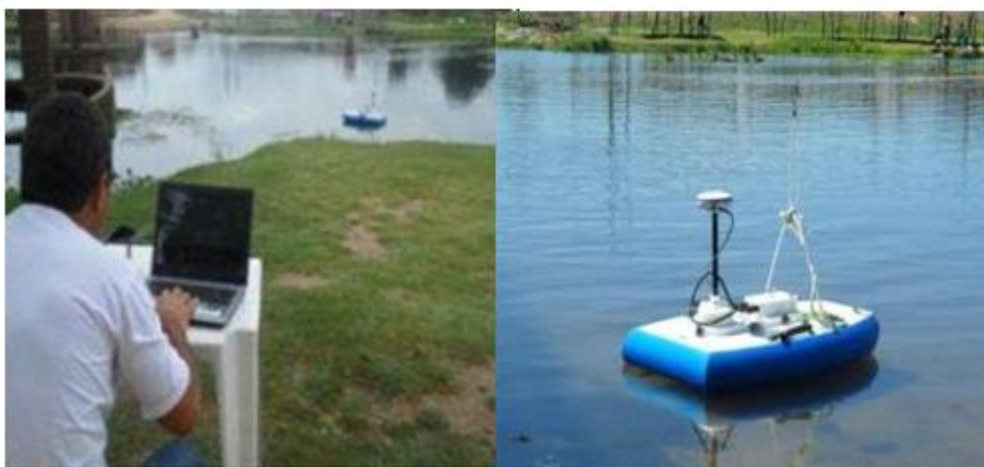
Figura 4 – Medição de vazão com o ADCP na seção transversal do Rio Piancó. Fonte: Arquivo pessoal (2012). Arquivo pessoal (2011)
