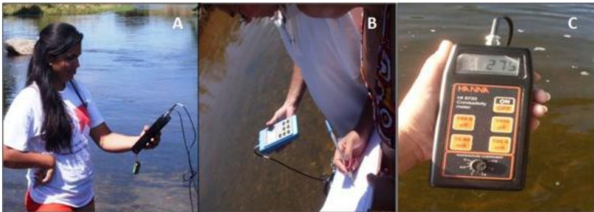
Figura 5 - Determinação dos parâmetros físicos químicos in locu - determinação do P(A), oxigênio dissolvido (B) e condutividade elétrica (C). Arquivo pessoal (2011)
