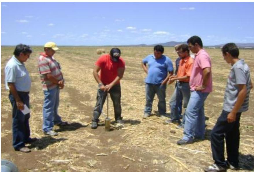
**Figura 6 - Coleta de amostra de solo deformado com anel volumétrico. Fonte: Arquivo pessoal (2010)**
