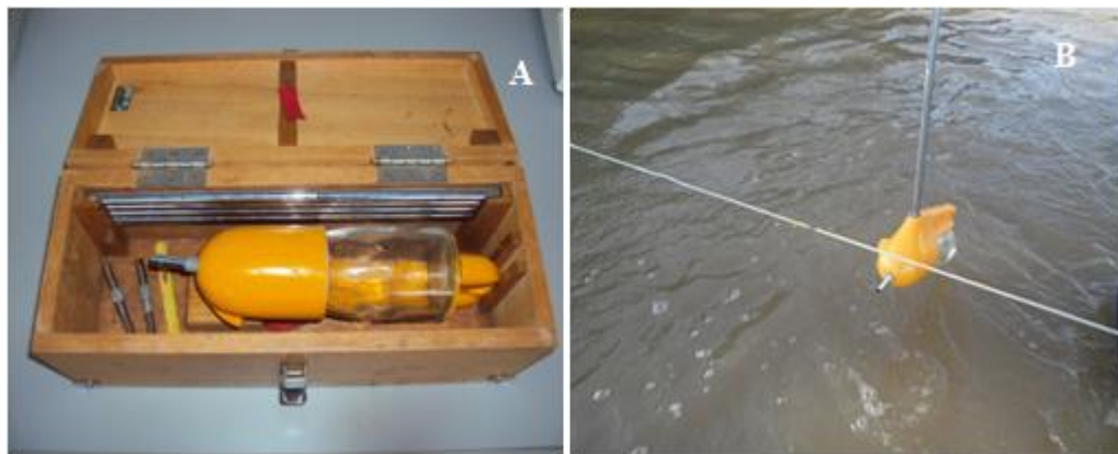
Figura 4 – Amostrador DH- 48 (A) e sua utilização (B). Fonte: Arquivo pessoal (2012)
