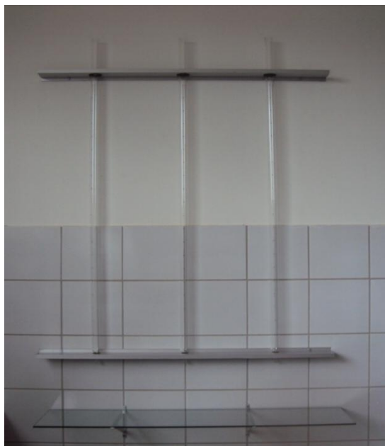
Figura 6 - Conjunto de três tubos de vidro graduados para método do tubo de retirada pela base. Fonte: Arquivo pessoal (2012)
