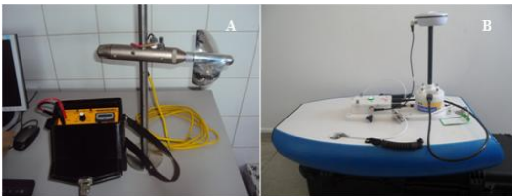
Figura 2 - Molinete fluviométrico e contador eletrônico de pulso (A) e Medidor Current Acústico Doppler (B). Fonte: Arquivo pessoal (2012)
