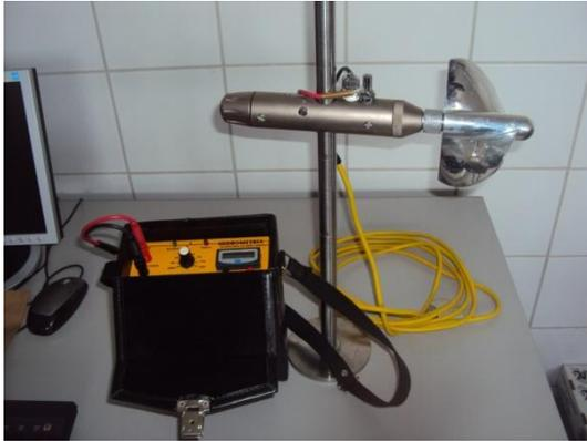
**Figura 3- Molinete Fluviométrico com Contador de pulsos. Fonte: Arquivo pessoal (2012)**
