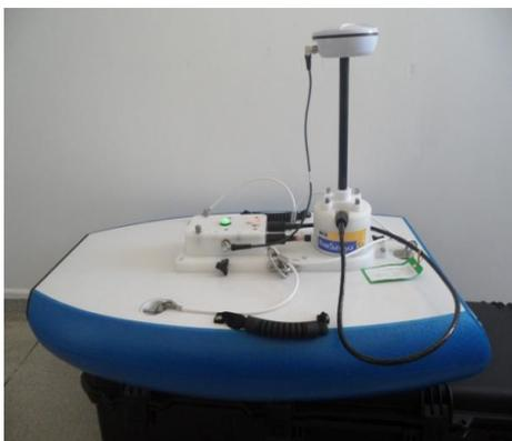
**Figura 5- Medidor acústico Doppler de vazão Fonte: Arquivo pessoal (2012)**
