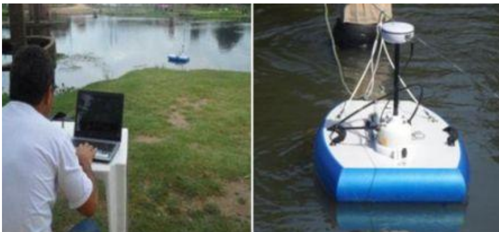
Figura 7 – Medição de vazão com o ADCP na seção transversal do Rio Piancó. Fonte: Arquivo pessoal (2012)
