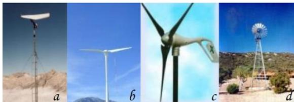
Figura 2 – Rotores de eixo horizontal : (a) 1 lâmina; (b) 2 lâminas; (c) 3 lâminas; (d) multipás. Fonte: minerva.ufpel.edu.br
