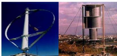
Figura 1 – Rotor Darrieus (à esquerda), Rotor Savonius (à direita). Fonte: opexenergy.com, mywindenergy.blogspot.com
