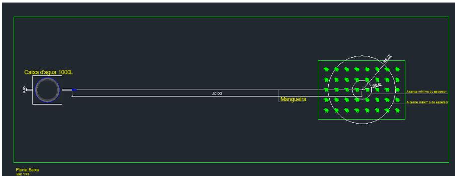
Figura 2: Mostra a imagem do terreno com todos os equipamentos utilizados na irrigação e como ficaram dispostos no terreno desenhado no AutoCAD. Fonte: Os autores 2012.
