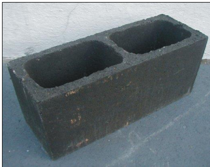
Figura 1 - Bloco de concreto produzido a partir de raspas de pneus usados.
