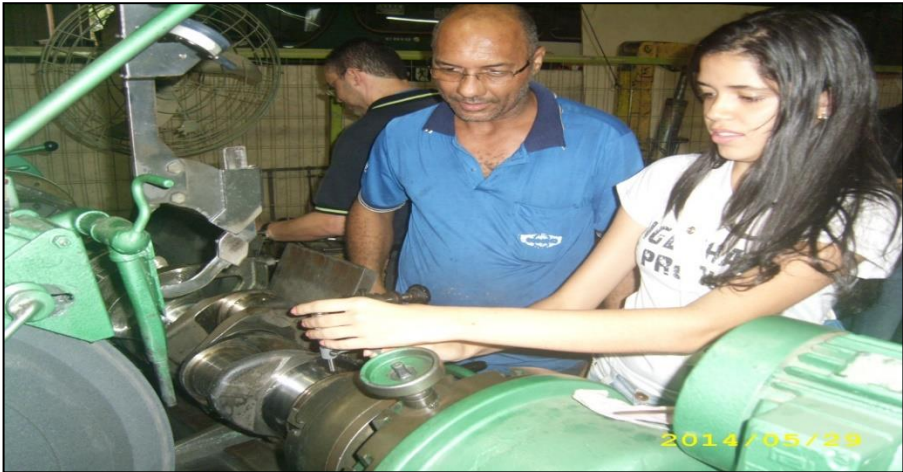
Fig.02. Estudante Larissa Delfino sob orientação do operador realiza medida do diâmetro de um eixo virabrequim utilizando o micrometro.
