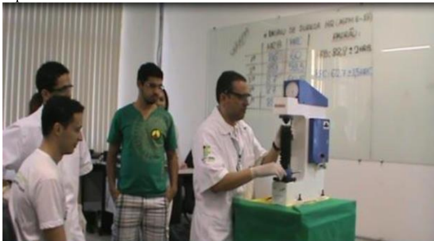
Figura 01- Realização do ensaio de dureza. Fonte: autores do artigo (2014)
