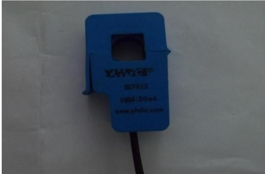
Figura 5 – Sensor de corrente elétrica modelo SCT-013-000
