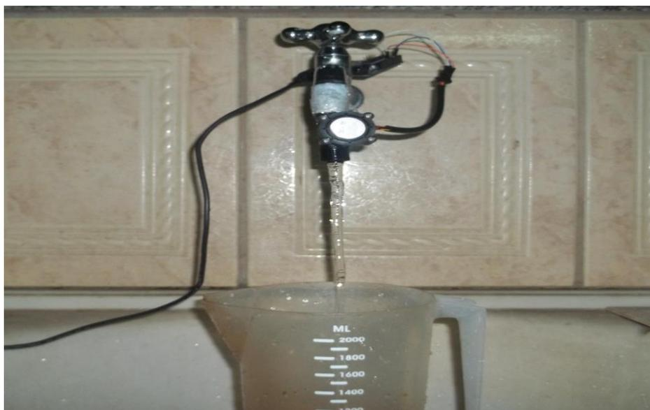
Figura 9 - Arranjo Experimental para calibração do Sensor de Vazão
