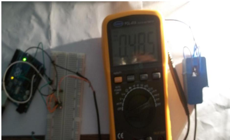
**Figura 8 – Arranjo Experimental para calibração do Sensor de Potência**
