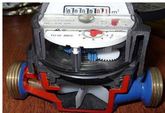
Figura 6 - Hidrômetro taquimétrico cortado
