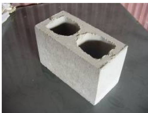
Figura 06 – Bloco de concreto produzido através de resíduo reciclado
