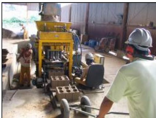
Figura 04 – Blocos prontos sendo transportados para a cura no pátio da Fábrica Fonte: PROHAB, 2007
