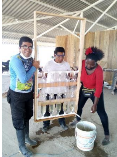
Figura 6. Modelo 1. Sistema de desinfección PET
