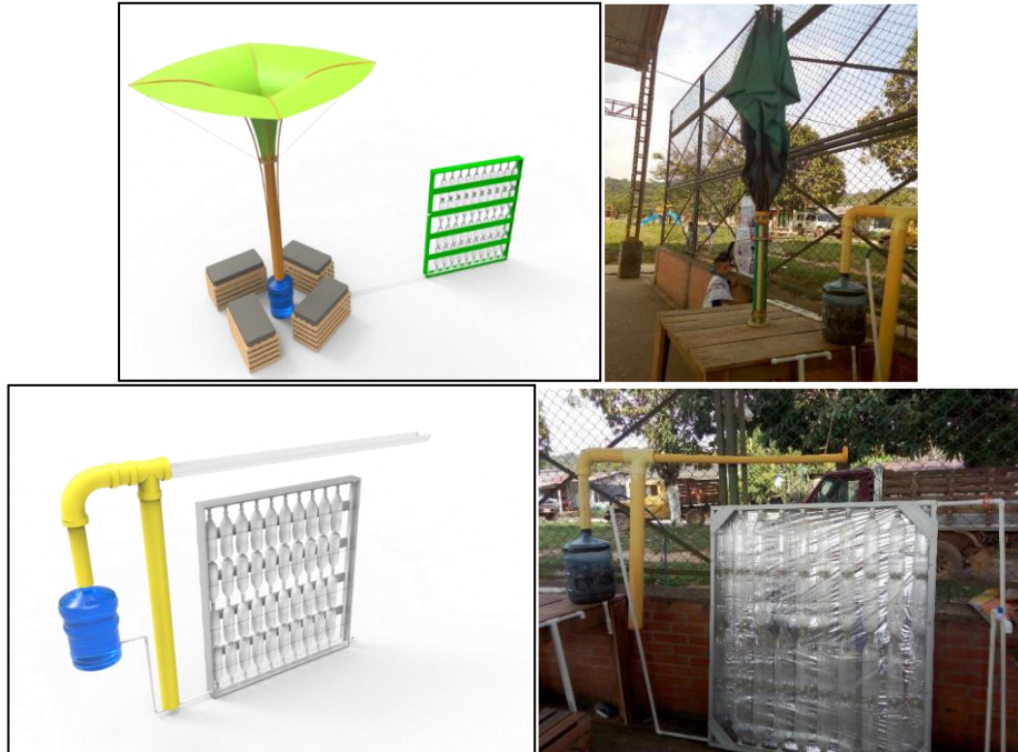
Figura 7. Prototipo sistema de captación de agua lluvia - SCALL móvil y fijo.
