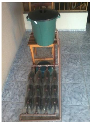
Figura 2 - Protótipo do coletor solar com materiais pós-consumo
