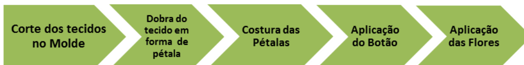
Figura 4- Processo produtivo do fuxico tipo flor sem preenchimento
