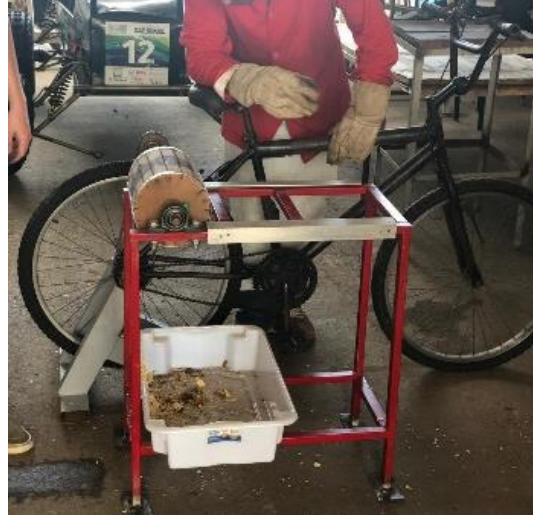
Figura 4 – Construção do protótipo da trituradora
