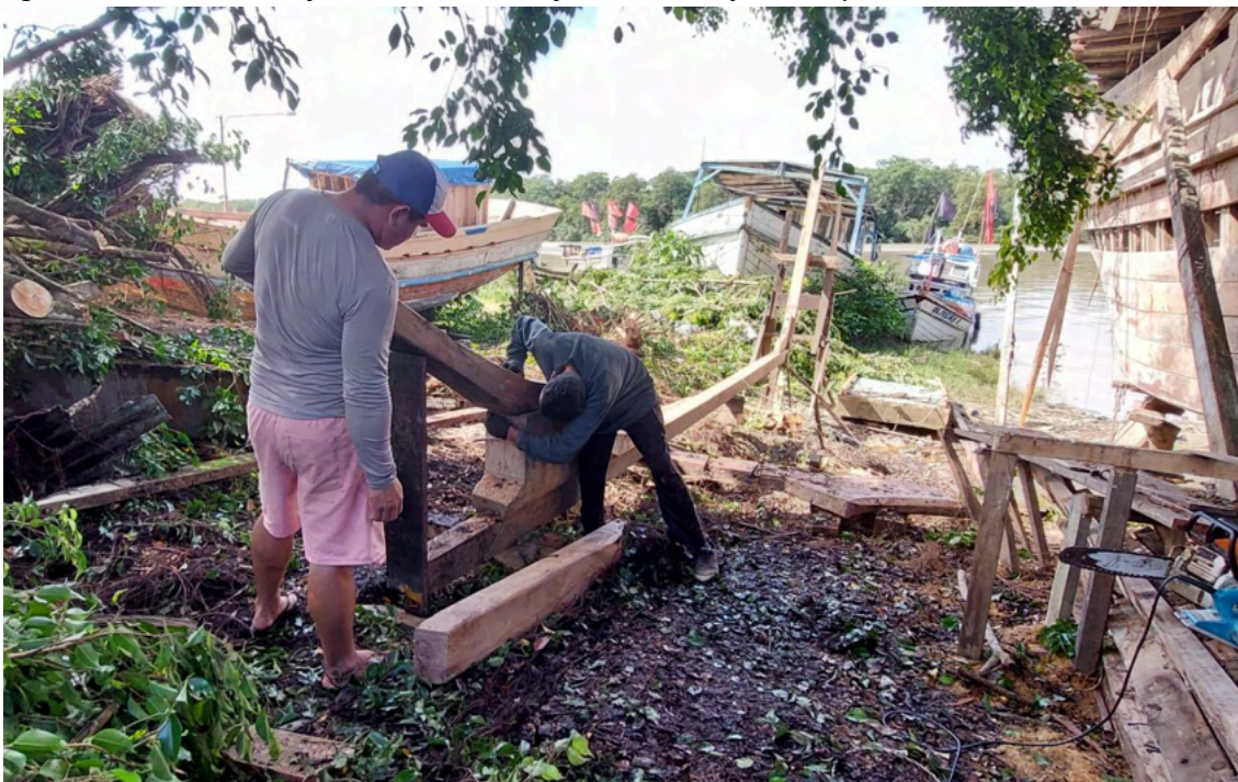
Figura 2. Início da construção de uma embarcação, o mestre ajusta a espinha sobre a bucha.
