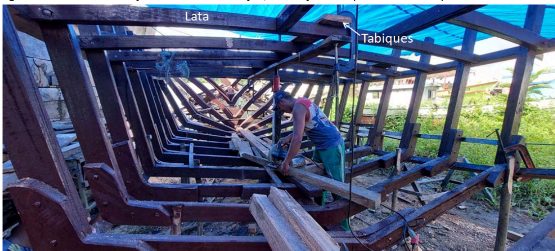
Figura 3. Interior da armação de uma embarcação, instalação e suspensão dos tabiques.
