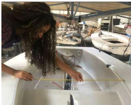
Figura 5: Extensionista tirando as medidas de um barco para convertê-lo em uma escala menor e desenhar seu modelo.
