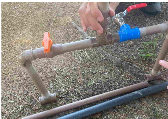
Figura 1: Clorador manual horizontal, construído pelos membros do CEPAE, UFSCar-LS
