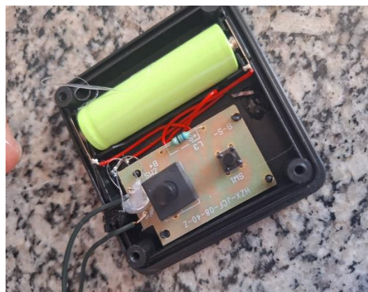
Figura 4 - Circuito elétrico consertado com cola quente
